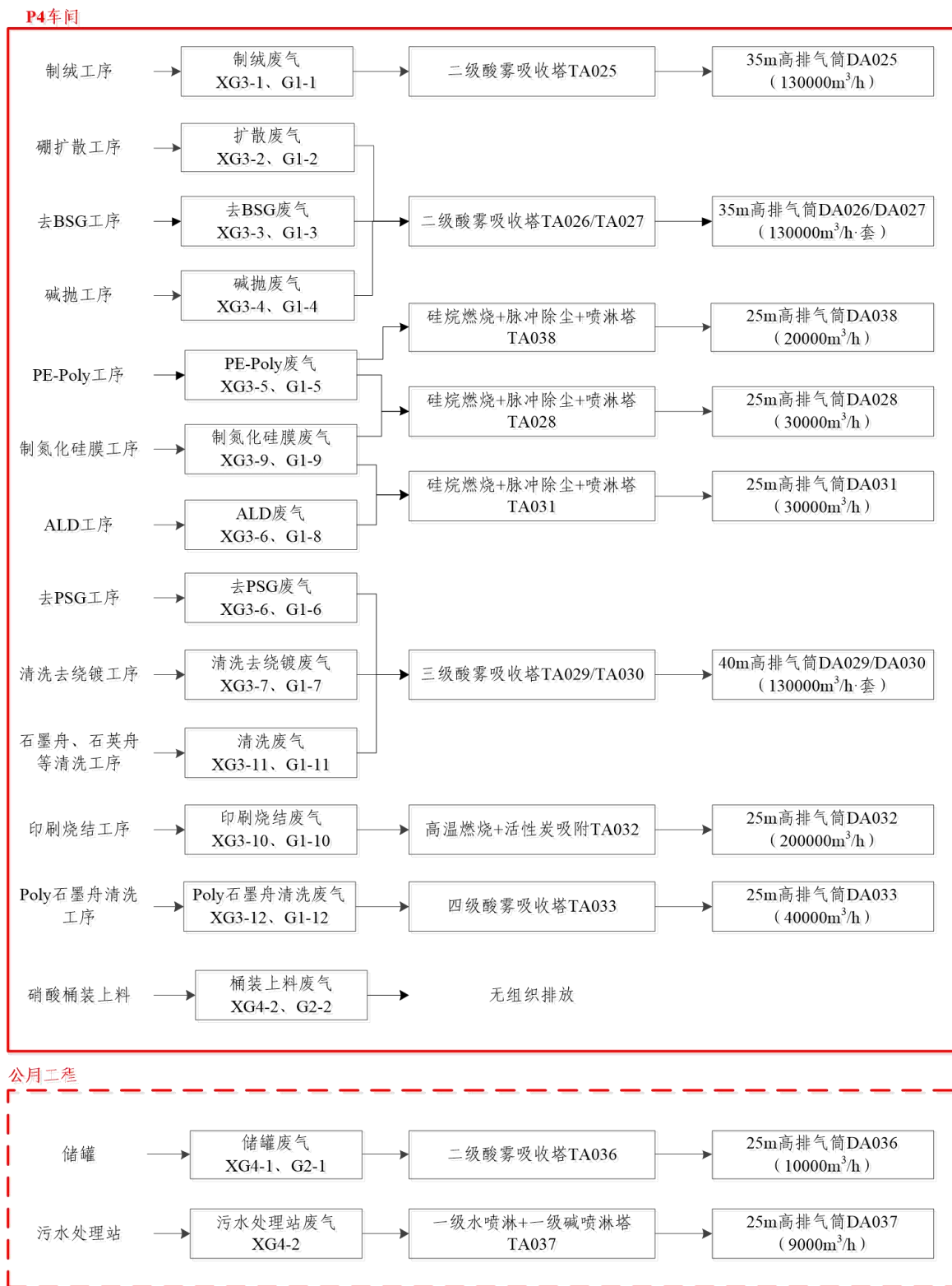
图 7-6 废气处理系统图
